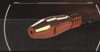
• Os tubos de contato são usinados a partir de tubos trefilados, garantindo um diâmetro interno consistente em relação à sua concentricidade e tolerância com o diâmetro externo. Este processo permite que o arame seja alimentado de forma constante, reduzindo o acúmulo de respingos.
