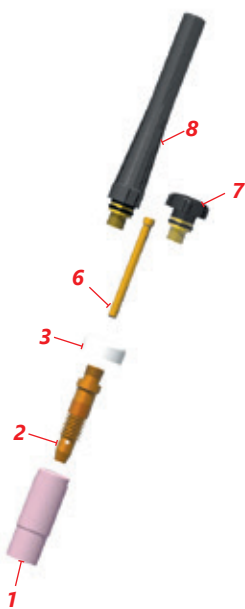
CORPO PARA USO DE REGISTRO Torch Body for Valve Use
