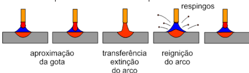
Figura nº6: transferência por curto circuito.
