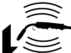
Figura 8.39: Stick Out Excessivo - Alerta Inferior (Vibração Constante)
