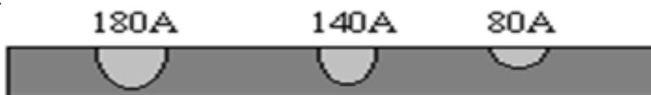
Figura nº8: Penetração de solda em função da corrente de soldagem.
