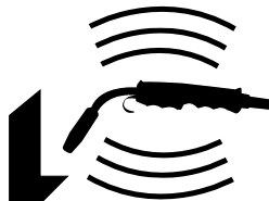
Figura 8.39: Stick Out Excessivo - Alerta Inferior (Vibração Constante)
