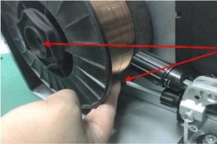
9. Coloque o rolo de arame no eixo carretel ( a porca do eixo carretel é rosca esquerda), e passe o arame pelo guia de entrada até a roldana;
