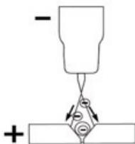
No circuito elétrico DC, existe um princípio elétrico em funcionamento que deve sempre ser levado em consideração. Nesse circuito, maior parte do calor está concentrado no lado positivo. Isso precisa ser entendido pois determina qual conector a tocha TIG será conectada.
