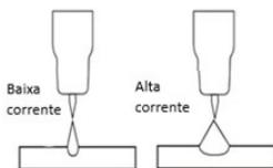
A intensidade do arco é proporcional à corrente que flui no tungstênio. O soldador regula a corrente de soldagem para ajustar a potência do arco. Um material de espessura mais fina requer um arco menos potente, com menos calor para fundir o material, portanto, uma corrente menor é necessária. Um material mais espesso requer um arco mais potente, com mais calor, portanto, uma corrente maior é necessária para fundir o material.
