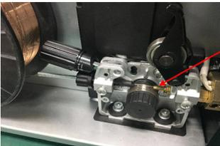
10. Passe o arame pela roldana e tubo capilar, e após empurre cerca de 150mm;
