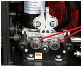
7.1.10 Coloque o rolo de arame no eixo carretel. Passe o arame pelo guia de entrada e guia central até o tubo capilar, através das Roldanas. Após, empurre o arame cerca de 150mm;
